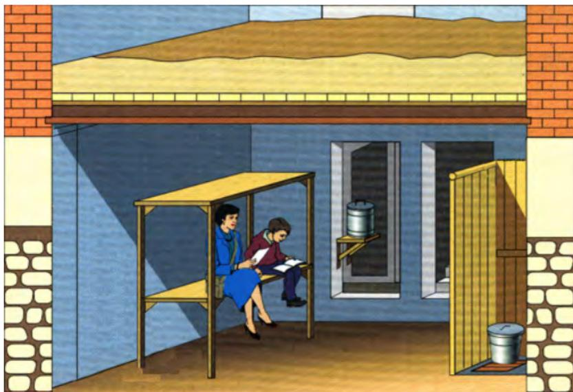
Рис. 4 — Подвал, приспособленный под укрытие
